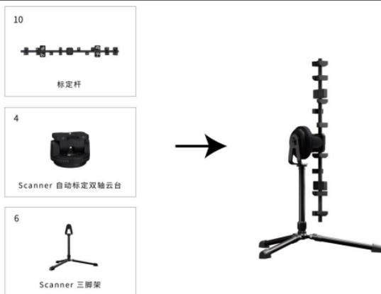
5) **准备其他配件：**取出标定板三脚架和定位垫备用，用于后续手眼标定。
