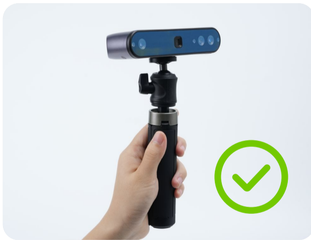
图 2: 手持三脚架进行手持式扫描。
